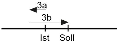
Nach Erreichen der Sollposition wird diese Position mit dem internen Absolutencoderstand verglichen. Bei einer Abweichung um mehr als  $0,9^\circ$  (an der Motorwelle) wird automatisch eine Zweitpositionierung gestartet und der Antrieb wird die Zielposition erneut anfahren. Bei einer weiteren Abweichung um mehr als  $0,9^\circ$  wird das Status-Bit „Positionierfehler (Blockieren)“ gesetzt.
