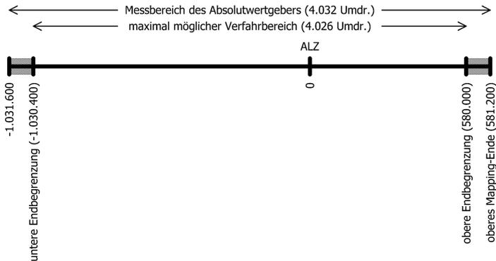
Hier wurde das obere Mapping-Ende vom Wert 806.400 auf den Wert 581.200 verringert. Somit liegen ein höherer Anteil des möglichen Verfahrensbereichs im negativen Bereich und ein kleinerer Anteil im positiven Bereich.
